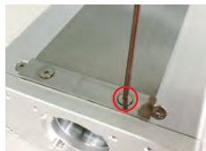
2、用内六角扳手拆开钢带压块
