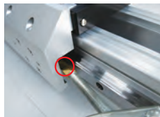
2、注入润滑脂后，并安装螺丝堵头
