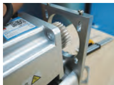
电机轴装上同步轮，把电机装入电机安装板与电机调节板连接并保持松弛状态
