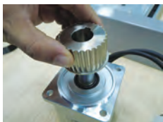
电机轴装上同步轮，把电机装入电机安装板与电机调节板连接并保持松弛状态
