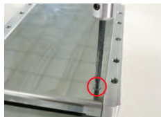
1、用十字螺丝刀拆开防尘盖板
