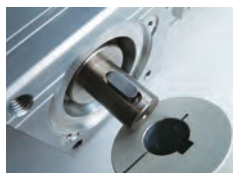
2、拔掉需要更换的联轴器
