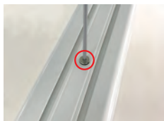
用内六角扳手拆开螺丝
