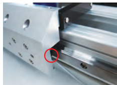
1、用内六角扳手打开滑块螺丝堵头
