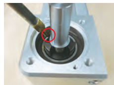
4、部分产品电机端轴承需半年注油
