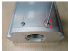
用内六角扳手拆开上盖四个螺丝
