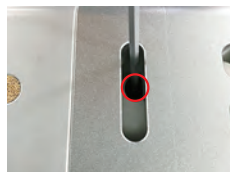
检查联轴器螺丝是否松动
