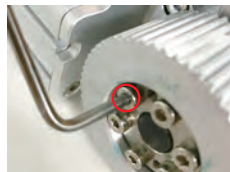
检查同步轮螺丝是否有松动
