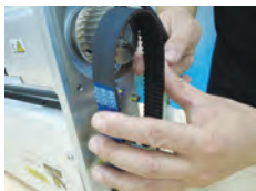
用皮带连接两个同步轮
