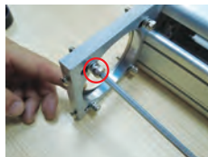
拆掉电机调节板
