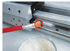
3、表面涂抹润滑脂，防止导轨生锈
