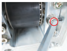
3、调节螺丝，张紧同步带，并滑动滑 台使同步带处于同步轮的中间位置
