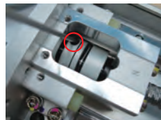
拧紧电机与联轴器固定螺丝
