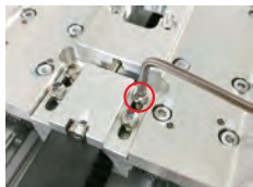
1、松动同步带夹板螺丝
