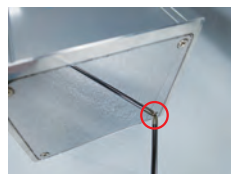
4、锁紧侧顶防松螺丝，安装端盖
