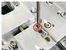
3、拧紧同步带夹板螺丝
