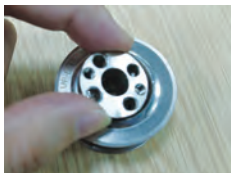
把张紧套放入同步轮对齐四个螺丝孔
