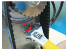
用扳手调节皮带松紧度
