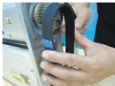
用皮带连接两个同步轮
