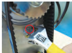
用扳手调节皮带松紧度
