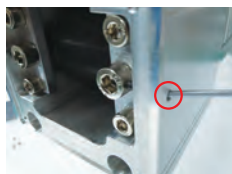
2、松开侧顶防松顶丝进行平衡调节 观察皮带轮皮带是否平行
