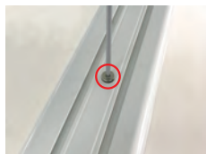
用内六角扳手拆开螺丝
