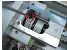
拧紧电机与联轴器固定螺丝
