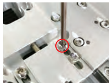
3、拧紧同步带夹板螺丝
