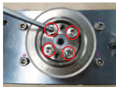
把同步轮装入丝杆，调整张紧套与丝杆端面平齐并拧紧四个螺丝 (注:与拆卸孔区分)
