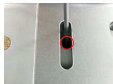
检查联轴器螺丝是否松动
