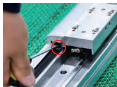
用内六角扳手调节皮带张紧度
