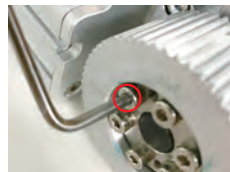
检查同步轮螺丝是否有松动
