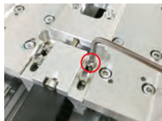
1、松动同步带夹板螺丝
