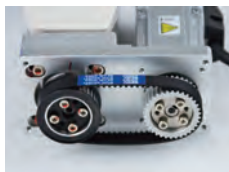
用皮带连接两个同步轮
