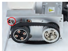
用内六角扳手调节皮带松紧度
