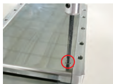
1、用十字螺丝刀拆开防尘盖板
