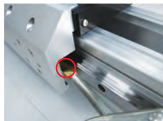
2、注入润滑脂后，并安装螺丝堵头
