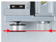
对齐电机同步轮和滑台同步轮
