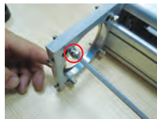
拆掉电机调节板
