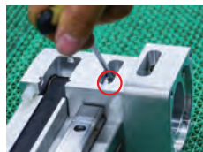
检查联轴器螺丝是否松动
