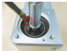
4、部分产品电机端轴承需半年注油
