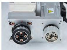
电机轴装上同步轮并锁紧同步轮螺丝
