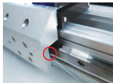
1、用内六角扳手打开滑块螺丝堵头
