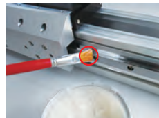
3、表面涂抹润滑脂，防止导轨生锈
