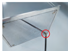
4、锁紧侧顶防松螺丝，安装端盖
