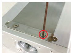
2、用内六角扳手拆开钢带压块
